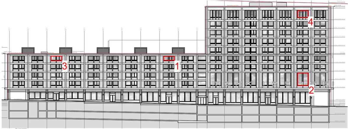
Abb. 5: Fassade mit ausgewählten Fassadenpunkten (Fenster 1-4) zur Bestimmung der Wärmestromdichten
