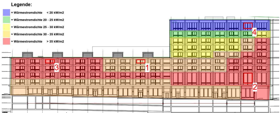
Abb. 12: Diagramm Wärmestromdichte mit eingezeichneten Beispiels-Fassadenpunkten
