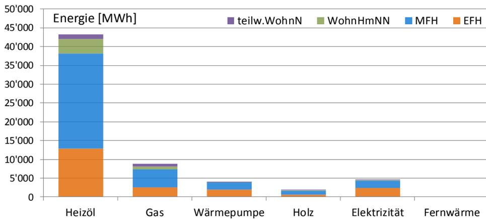
Abbildung 4: Benötigte Wärmeenergie in [MWh/a] nach Energieträger der Heizung und Gebäudekategorie. Illustration der Tabelle 7. Auszug GWR: 29. Mai 2015. Meggen.
