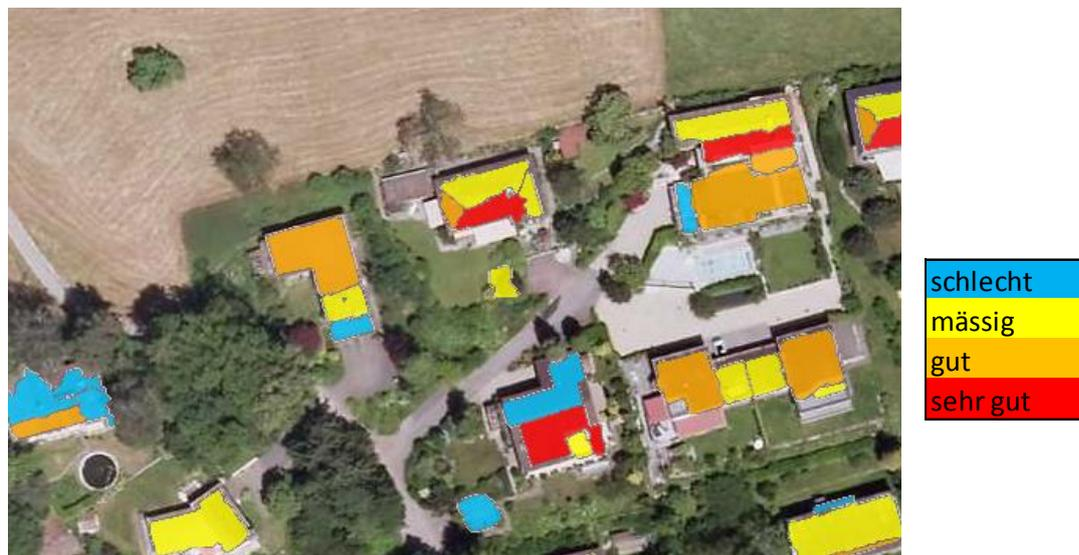
Abbildung 7: Beispiel Solarpotentialkataster.
