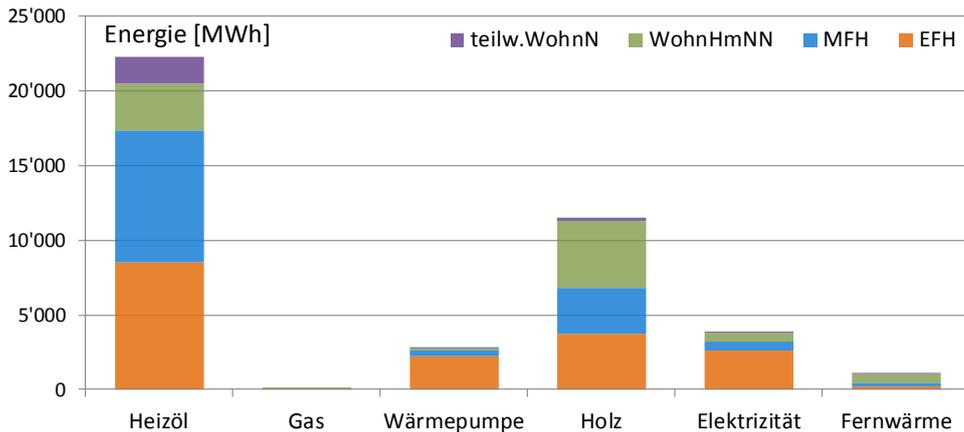
Abbildung 4: Benötigte Wärmeenergie in [MWh/a] nach Energieträger der Heizung und Gebäudekategorie. Illustration der Tabelle 7. Auszug GWR: 29. Mai 2015. Hitzkirch.
