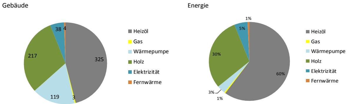
Abbildung 5: Anteile der Energieträger der Heizung nach Anzahl Gebäude und nach Anteil des Beitrages an der Wärmeenergie: Auszug GWR: 29. Mai 2015. Grosswangen.
