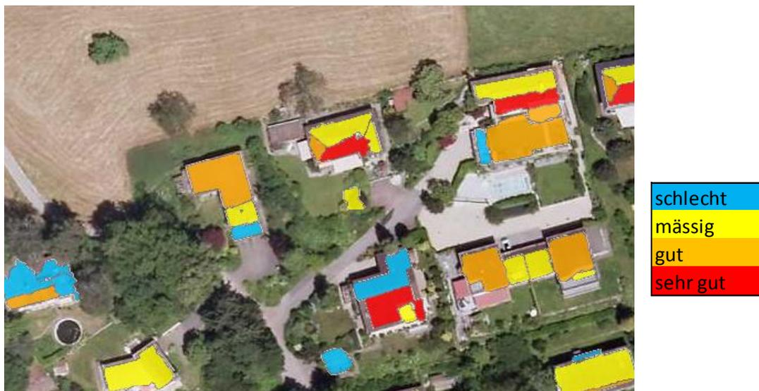
Abbildung 7: Beispiel Solarpotentialkataster.
