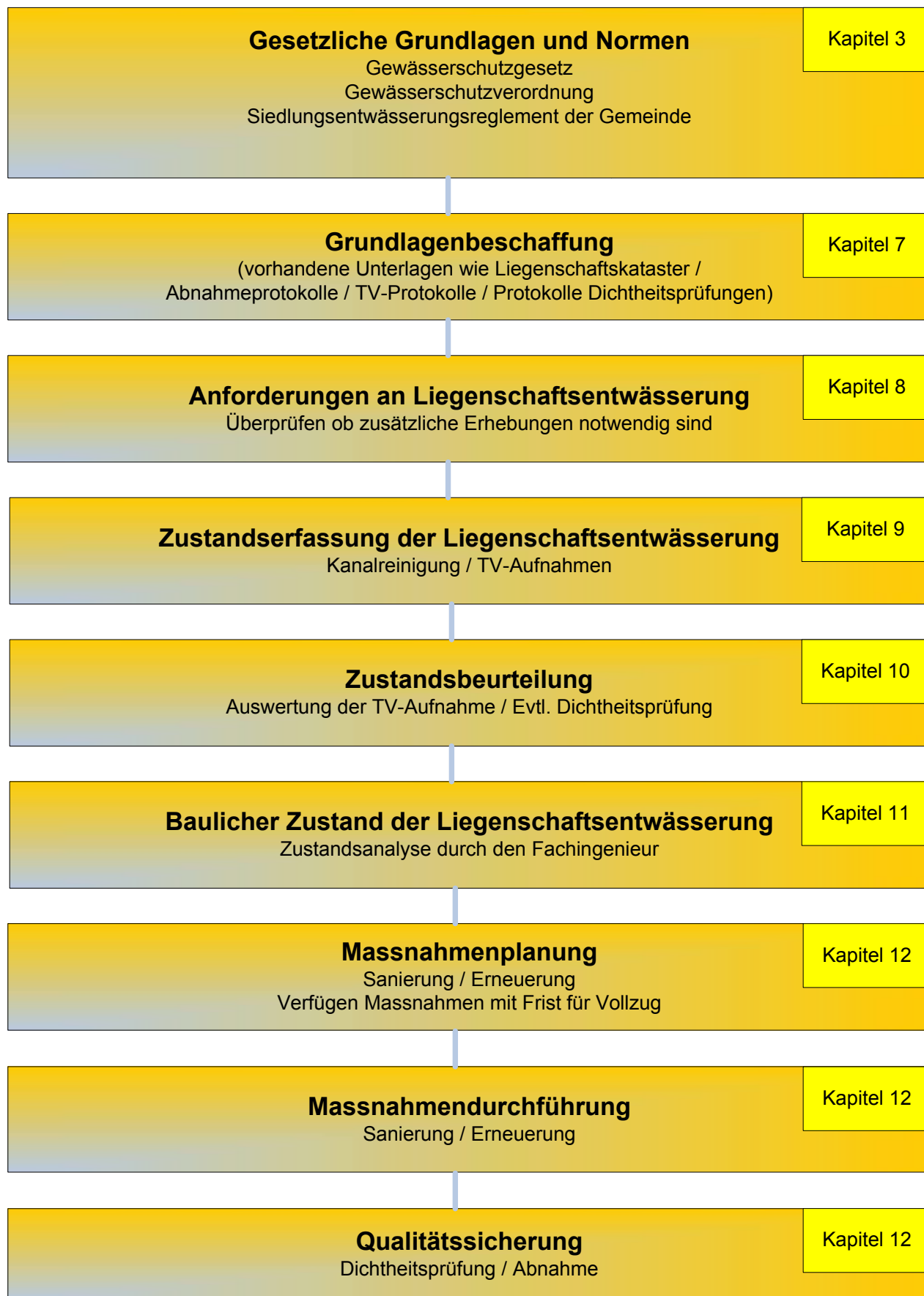
Abbildung 4: Vorgehensweise im Kanalisationsunterhalt im Liegenschaftsbereich
