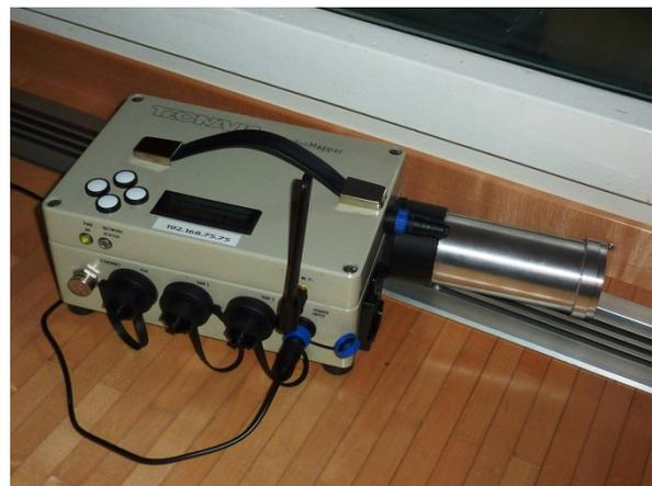
Abb. 2. AlphaGUARD Radonmonitor und Gammadata Passivdosimeter (oben rechts).      Abb. 3. RadonMapper Radonmonitor.
