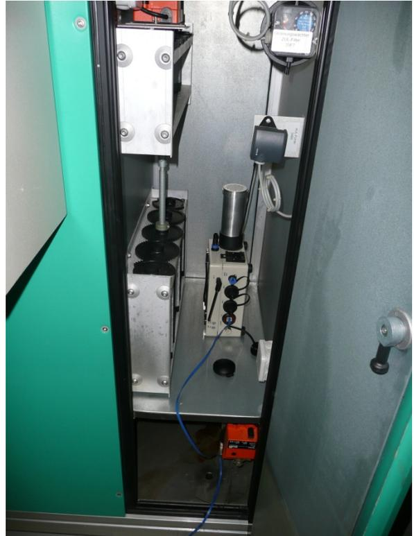
Messung der Radonkonzentration in der Luft aus dem L-EWT im Lüftungsgerät
