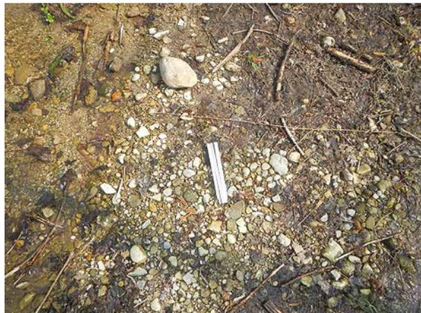
**Bild 39** *Geringfügige Ablagerungen von Feingeschiebe, Feinsedimenten und Schwemmgut in der kleinen Aufweitung (27.3.2014).*
