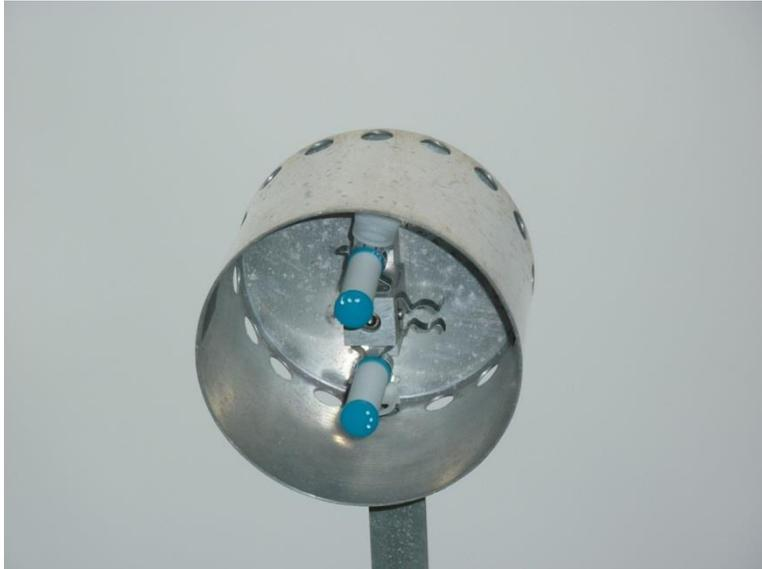
Abbildung 3: Zwei NH<sub>3</sub>-Passivsammlerröhrchen im Wetterschutzgehäuse.
