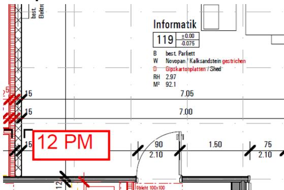
**Beispiel 5:** Einzeichnen der Dosimeter bei Doppelmessungen in Grundrissplan (Ausschnitt)
