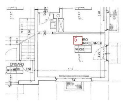
Beispiel 4: Einzeichnen der Dosimeter bei Parallelmessungen in Grundrissplan (Ausschnitt)
