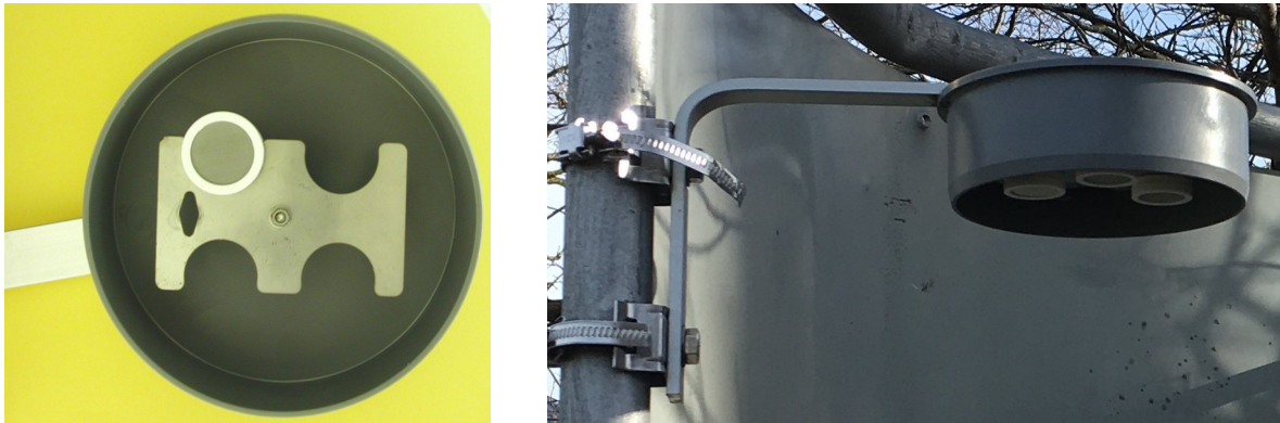
Abbildung 7: Ein Ferm-Passivsammler im Einsatz. 46 Pro Messpunkt werden immer mindestens zwei Messungen durchgeführt und gemittelt, um die Messgenauigkeit zu erhöhen.
