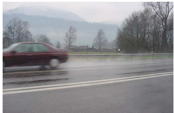
Abb. 4.8 Regennasse Fahrbahn (Sprühhahnenbildung)
