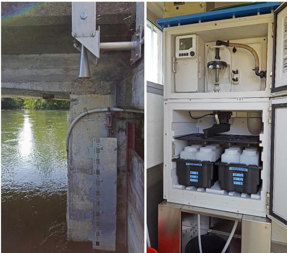
**Abbildung 8:** Hydrometrische Mess- und Probenahmestation Frauental an der Lorze. Foto links: Pegelmessung mit Radar und Ansaugschlauch des Wasserprobennehmers. Foto rechts: Dosiereinheit für Wasserproben integriert in Kühlschrank. *Quelle Fotos: AFU Zug*
