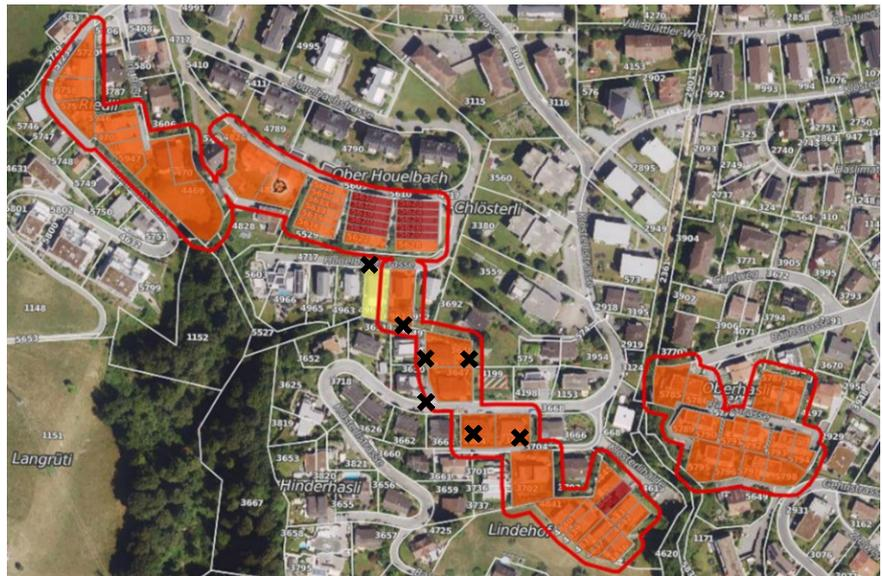
Abbildung 1 Langgezogenes Lärmrisikogebiet mit Verkleinerungspotenzial aufgrund des Vorhandenseins potenzieller Aufstellorte, welche eine Schallkumulation minimieren.
