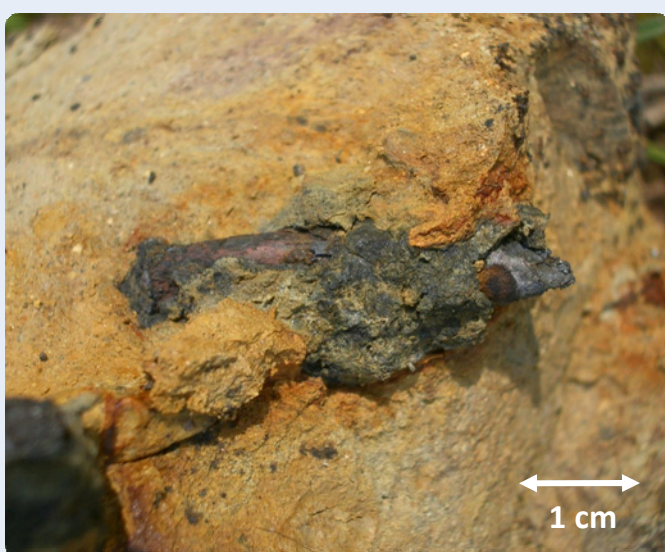
Mit der Korrosion der Projektile im Boden können toxische Elemente freigesetzt und mobilisiert werden (Foto: VBS).
