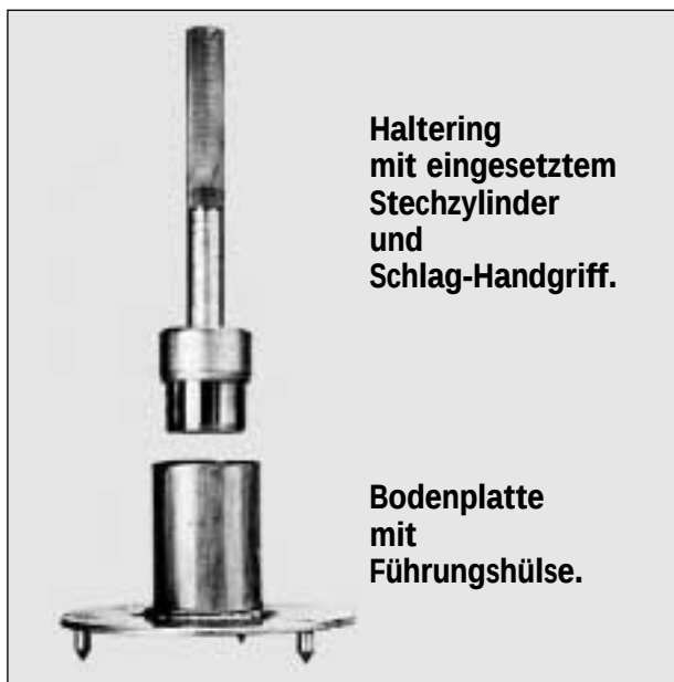
Abb. 48: Die Abbildung zeigt ein 100 ml Entnahmeset.
