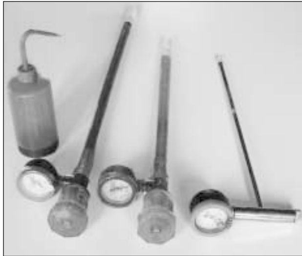
Abb. 47: Manometer-Tensiometer verschiedener Baulängen/-arten und Zubehör.
