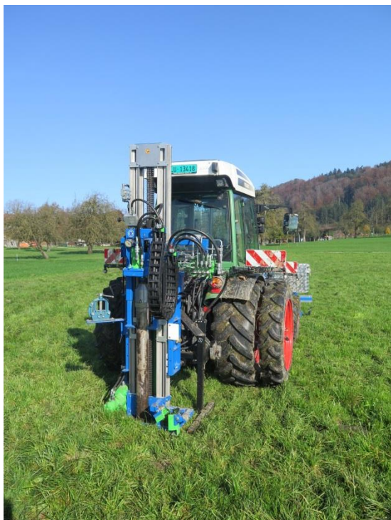
Abbildung 1: Bohrfahrzeug mit Bohrkernsammelbehälter (Foto re.)(Fotos: S. Schneider)
