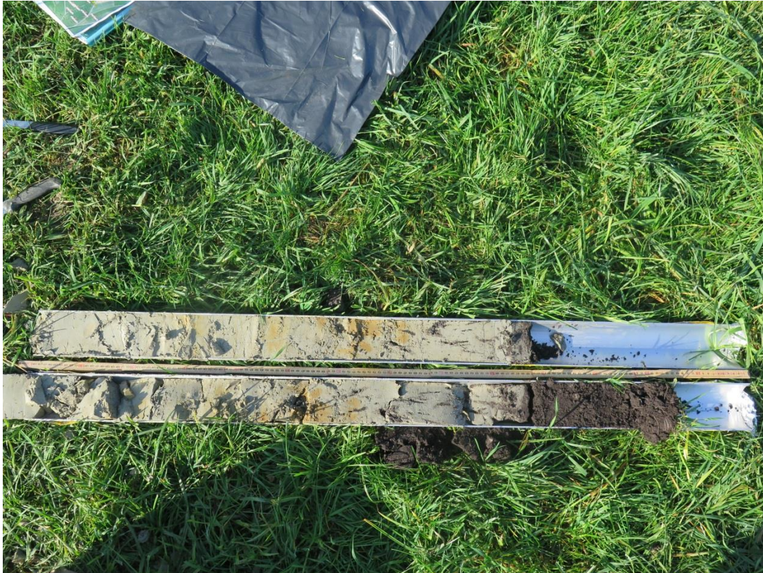
Abbildung 2: 2 Bohrkernhalbschalen (10cm Durchmesser)(Fotos: S. Schneider).
