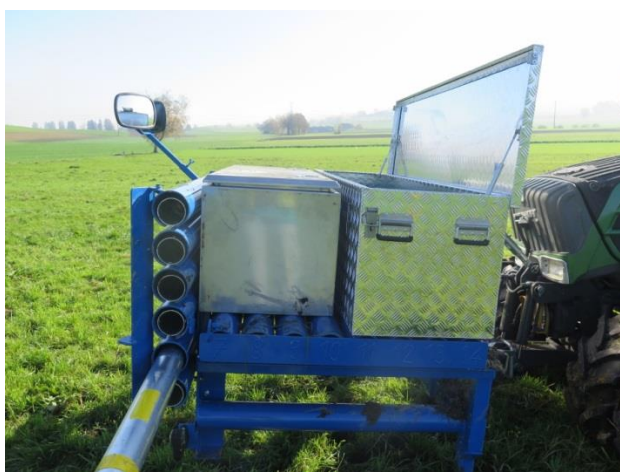
Abbildung 1: Bohrfahrzeug mit Bohrkernsammelbehälter (Foto re.)(Fotos: S. Schneider)
