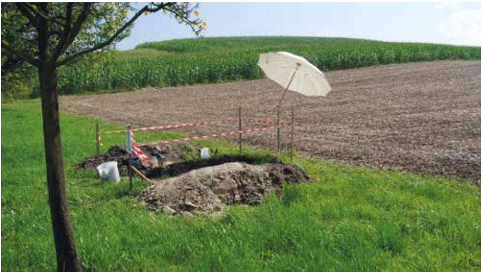
In der **zweiten Phase** wird ca. alle 50 Meter mit dem Bohrstock (ca. 5 cm Durchmesser und 1 m tief) ein kleines Bodenprofil ausgestochen und vor Ort beurteilt. Diese Bohrungen dienen der flächenhaften Information. Im Anschluss können damit die verschiedenen Bodeneinheiten abgegrenzt und beschrieben werden.
