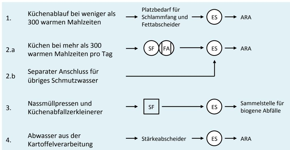
Auszug aus SN 592 000:2012 (ES: Einstiegschacht, SF: Schlammfang, FA: Fettabscheider, SB: Sammelbehälter ohne Abfluss)
