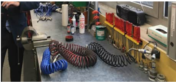
Spiralschläuche nur für die letzten Meter einsetzen.
